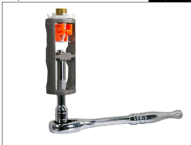
La clef modèle W4 inclut deux jeux de mâchoires. Un jeu de mâchoires équivaut à une clef modèle GFR2 et l'autre jeu de mâchoires équivaut à une clef modèle W1. Utiliser le plus petit des deux ensembles de mâchoires qui s'adapteront sur les méplats de la clef de gicleur. La clef W4 est utilisée en conjonction avec le cliquet carré à entraînement carré de 1/2 po nominal de l'installateur et la rallonge nominale de 5 po (125 mm) (non fournie) comme illustré à la Figure 13.
