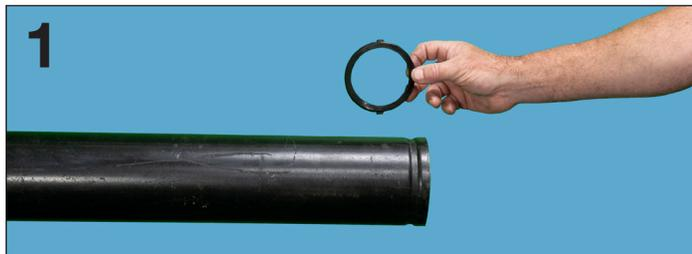
**1.** Desmonte o Tee mecânico e inspecione a junta para garantir que não esteja danificada e seja apropriada para o serviço pretendido. Inspeção a tubulação onde pretende instalar o tee mecânico, certificando-se de que seja redonda e não apresente danos na tubulação que possam prejudicar a vedação da junta.
