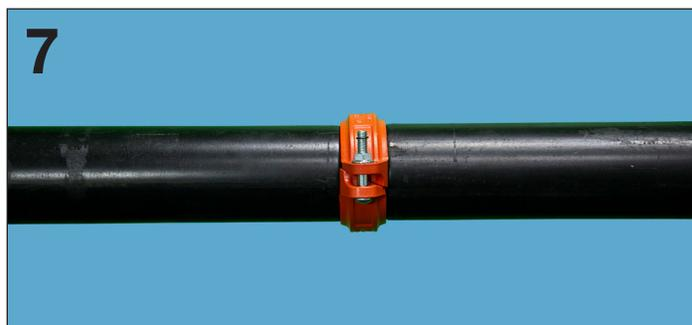
**7.** Inspeção visualmente os apoios dos parafusos em cada lado do acoplamento para garantir que o contato metal com metal seja alcançado e consistente. Inspeção também para garantir que a lingueta nos meios acoplamentos estejam totalmente encaixadas nas ranhuras do tubo.
