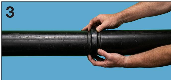
**3.** Alinhe e posicione juntas as extremidades do tubo correspondente. Deslize a junta para a posição centralizada entre as ranhuras em cada extremidade do tubo. Ambas as ranhuras devem estar visíveis.
