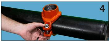
4. Inserte el perno en U (para 041) o alinee la carcasa de la Tee mecánica (MTT o MTG) con la carcasa de salida e instale las tuercas con los dedos para sujetar el conjunto de la T mecánica en su lugar sobre la tubería.
