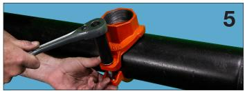
5. Apriete todas las tuercas en cantidades iguales mientras alterna entre todas las tuercas. Es importante apretar las tuercas de manera uniforme mientras se alterna el apriete de la tuerca para evitar que la junta se pellizque y asegurar un ajuste y sellado adecuados del ensamblaje en Tee mecánico sobre las tuberías. Esto es necesario tanto para herramientas manuales como de impacto.
