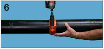
**6.** Deje de apretar las tuercas cuando se produzca un contacto de metal con metal entre las mitades superior e inferior del acoplamiento. El apriete excesivo de las tuercas a mano o con herramientas de impacto más allá de los límites de torsión especificados en la Tabla A para un tamaño de perno determinado puede dañar el acoplamiento y provocar fugas.
